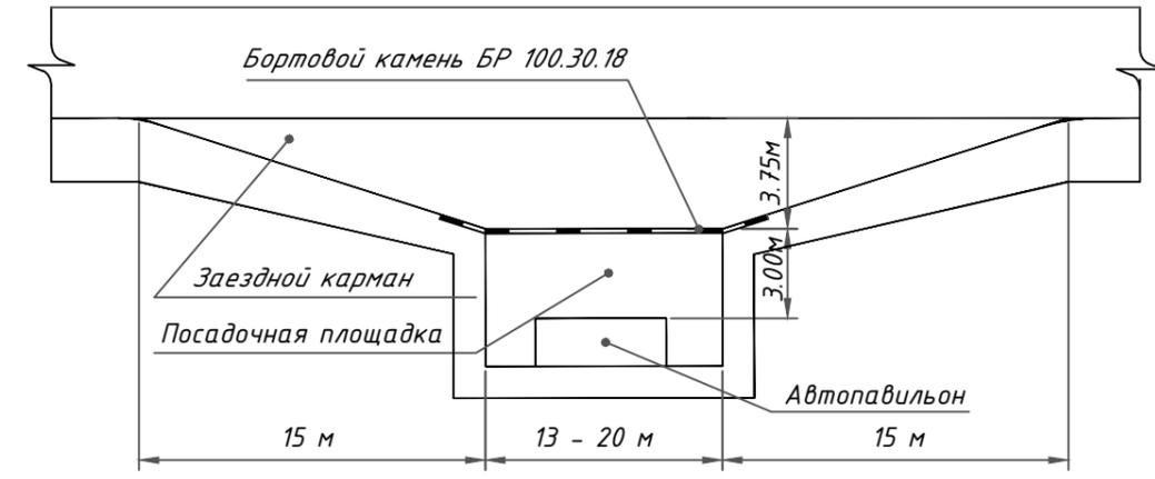
УСТРОЙСТВО БОРТОВОГО КАМНЯ
